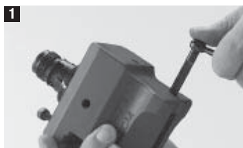
1 Sett på akslen med låsemekanismen i hullet som vist. Pass på at du ikke mister kulelageret.
