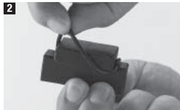
Einen neuen Gummi O-Ring wie abgebildet über das Schlagstück stülpen.
