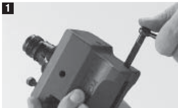
Die Achse mit Verriegelungshebel wie abgebildet in die Bohrung einführen und hineindrücken, bis sie einrastet.
