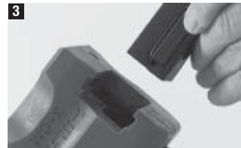
Das Dämpfelement auf das Schlagstück setzen und beide wie abgebildet in den Markierkopf einführen.
