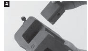
4 Insérer la culasse dans le boîtier de marquage et bien resserrer les vis de serrage M6×30 avec une clé pour vis à tête six pans creux.
