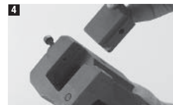
4 Sett på øvre og nedre del av stempelet og fest det med de 4 låseskruene M6×30 ved å bruke Loctite og en Umbraco nøkkel.
